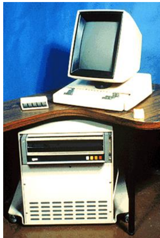
Экспериментальный компьютер Xerox Alto (1973 г.) может считаться первым персональным компьютером
