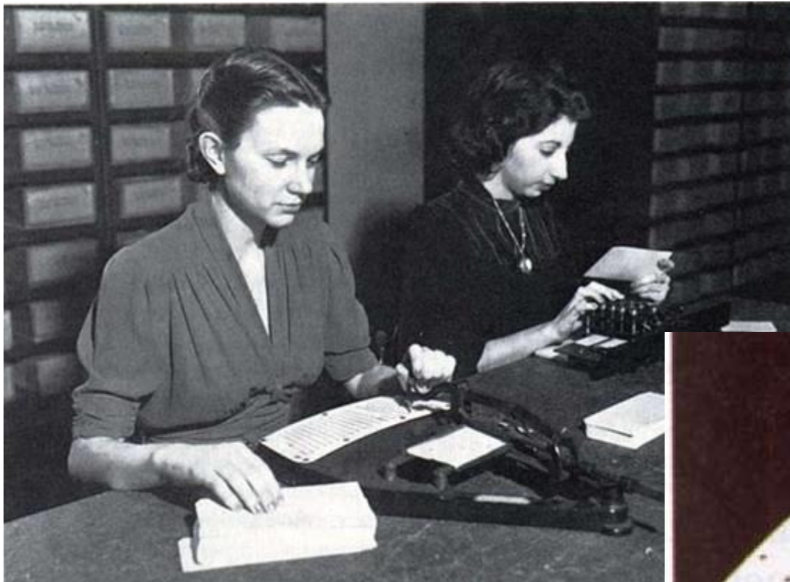
Пробивка отверстий в перфокарте Холлерита
